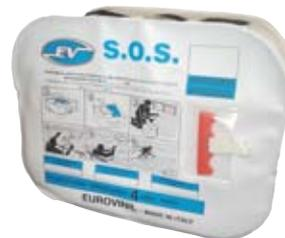
Sono mezzi di salvataggio a due camere indipendenti sovrapposte. Si attivano azionando la maniglia sulla valigia, grazie alle due bombole incorporate di CO<sub>2</sub> e azoto. Il loro funzionamento è garantito a temperature fra -18° C e +65° C.
